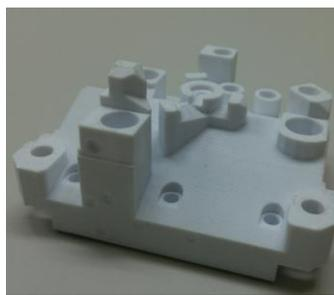
3Dプリンタによる造形モデルの製作例
