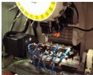
ファナックロボドリルによる 切削加工
