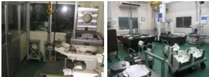
加工、検査・計測前に20℃の恒温室にワークを保管して品質を確保！
